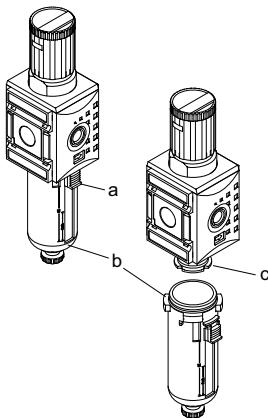
Beim Öffnen der Anlage unter Druck kann es zur Beschädigung der Wartungseinheit und schweren Verletzungen kommen.
