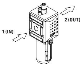
Filter, Filterregler und Öler in Wartungseinheiten oder als Einzelgeräte nur in senkrechter Lage einbauen.
