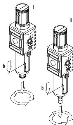
Beim halbautomatischem Kondensatablass wird Kondensat nur abgelassen, wenn der Behälter drucklos ist. Bei längerem Betrieb kann das Kondensat den maximalen Füllstand übersteigen und in die Druckluftanlage gelangen. Dies kann zur Beschädigung der Druckluftanlage führen.
